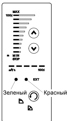
Рис. 42 Световые индикаторы на насосах с трёхфазными электродвигателями
